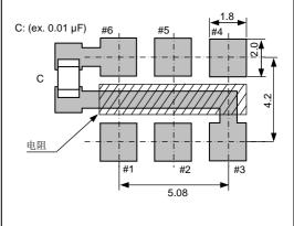
为了维持稳定运行,在接近晶体产品的电源输入 端处(在Vcc-GND之间)添加一个大概0.1uF的 去耦电容
